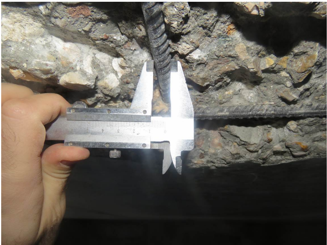
Рис. 2.5 (а, б). Уточнение сечений арматуры монолитных конструкций
